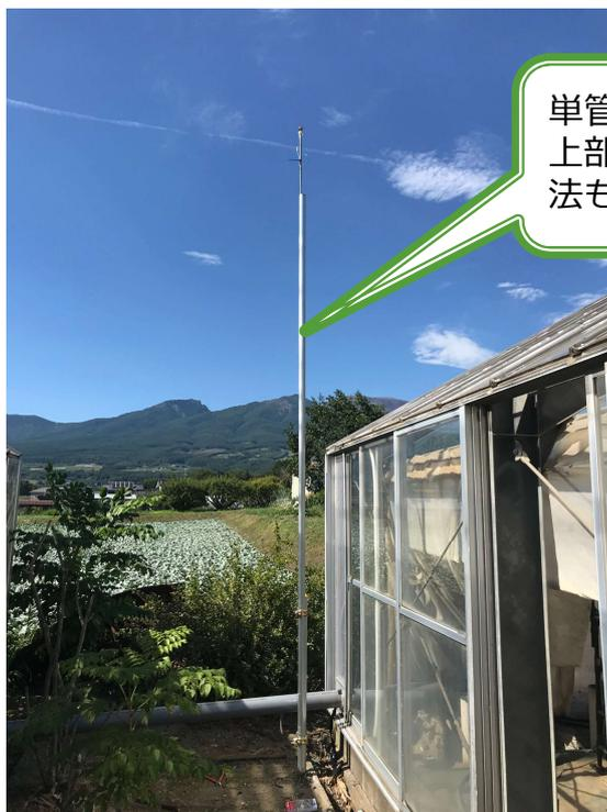
単管パイプを地中に挿して上部に日射計を取付する方法もあります。
