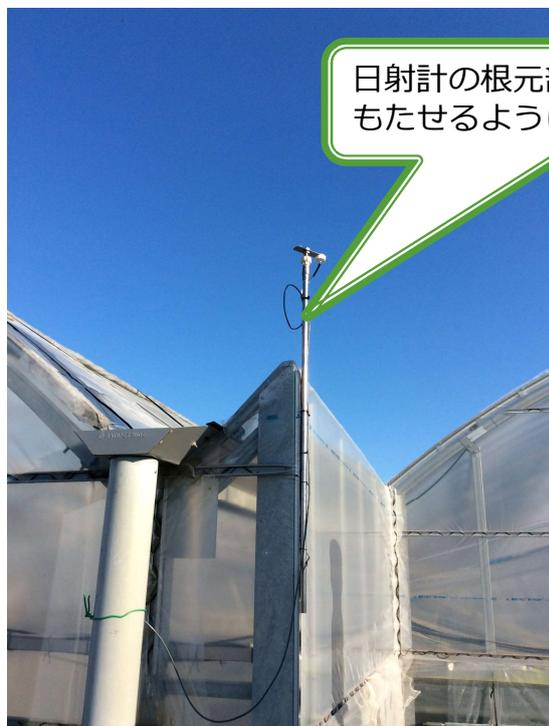
日射計の根元部分の線は遊びをもたせるようにしてください。
